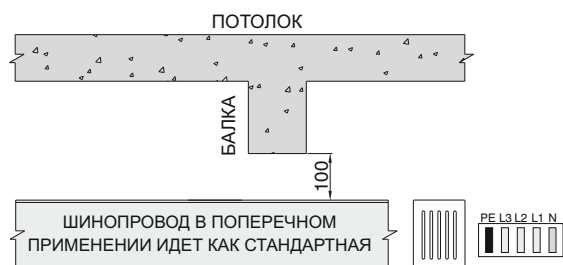
РИСУНОК 4 - ПЕРЕСЕЧЕНИЕ ПОД БАЛКОЙ А В ПОПЕРЕЧНОМ ПРИМЕНЕНИИ
